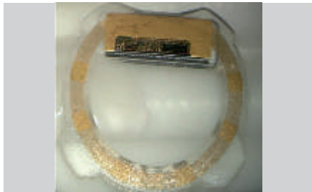
Abb. 1. Intraokularer Drucksensor zur Implantation in den Sulkus (Eyemate).
